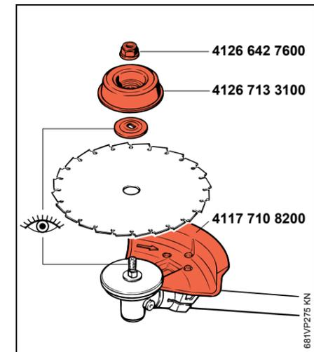
**D** **Achtung!** Unsachgemäß geschärfte oder stumpfe Werkzeuge können erhöhte Belastungen am Werkzeug verursachen. Werkzeuge regelmäßig kontrollieren und nach Vorschrift schärfen, beschädigte oder angerissene Werkzeuge nicht weiterverwenden. Unfallgefahr durch abbreißen Teile.
